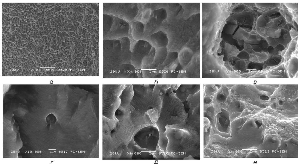
Рис. 6. Ямочный рельеф образца сплава 6061-Н в зоне стабильного РУТ (а), ускоренного РУТ (б); области (кластеры) хрупкого разрушения в зоне долома образца сплава 6061-Н (v); бороздчатый рельеф в зоне стабильного РУТ образца сплава 6061-Т6 (r); ямочно-бороздчатый рельеф в зоне ускоренного РУТ образца сплава 6061-Т6 (d); ямочный рельеф (область вязкого разрушения) в зоне долома образца сплава 6061-Т6 (e)
