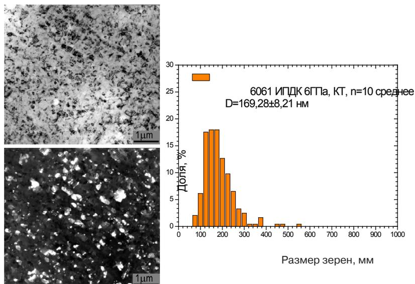
Рис. 5. Микроструктура образцов и размер зерна после ИПДК [12]
