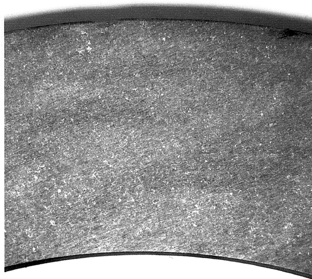
Рис. 2. Макроструктура стали кольца (×1)
