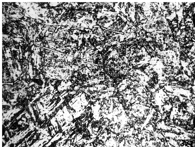
Рис. 3. Микроструктура стали кольца (×500)
