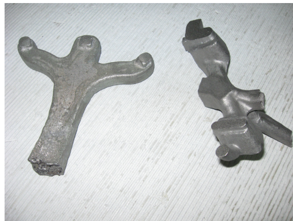
Рис. 2. Элементы литниково-питающей системы (слева до очистки справа – после очистки в дробемете и обдувки электрокорундом)
