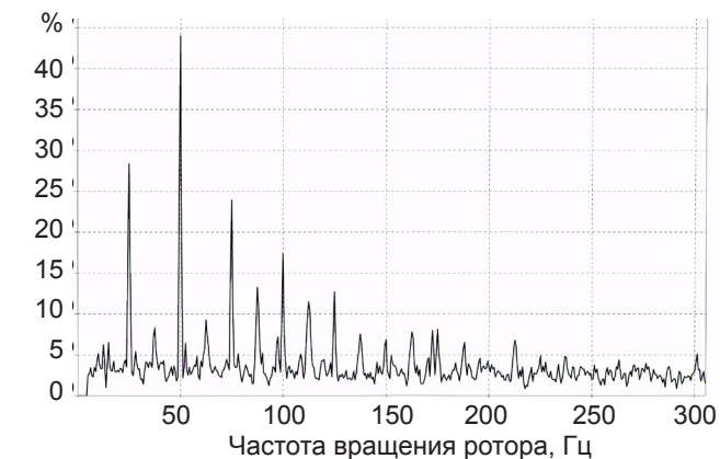
Рис. 3. Спектр огибающей высокочастотной вибрации вентилятора с колебаниями ротора
