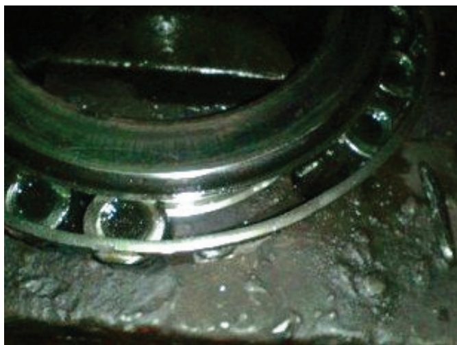
Рис. 6. Выбракованный подшипник мельницы среднего хода агрегата ПУТ
