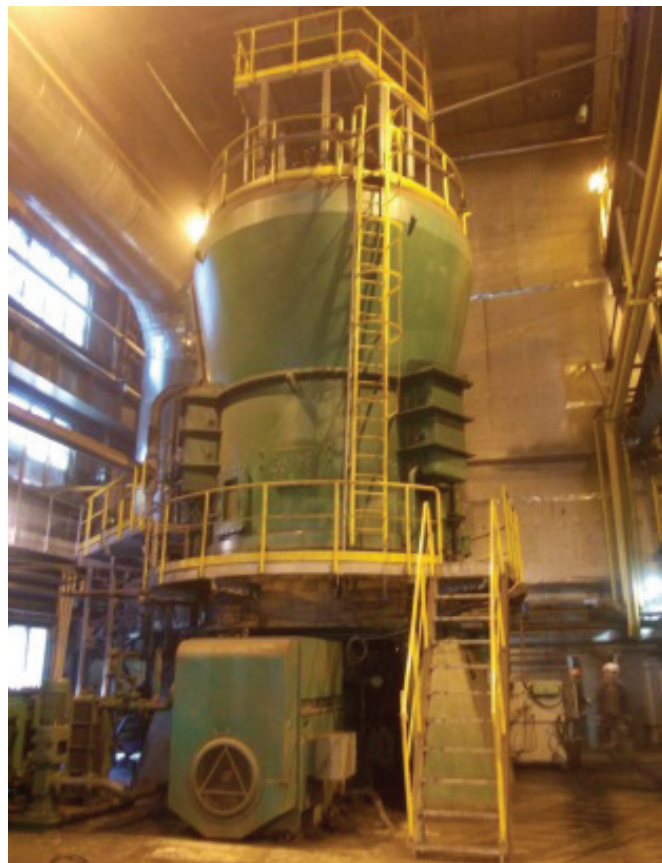
Рис. 4. Мельница среднего хода агрегата ПУТ
