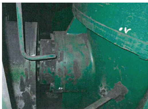
Рис. 2. Развивающийся дефект подшипника входного вала редуктора мельницы № 3 ПУТ
