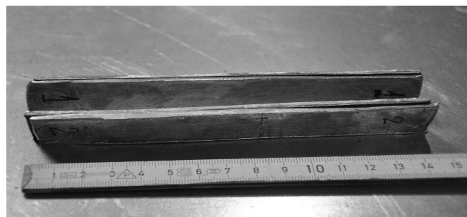
Рис. 2. Подготовленные к прокатке пакеты биметаллических алюминиево-стальных полос
