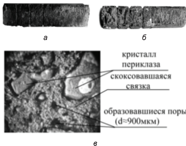
Рис. 3. Образование пор в теле огнеупора после температурной обработки: а – исходный образец; б – образец после отжига; в – макроструктура образца, x100
