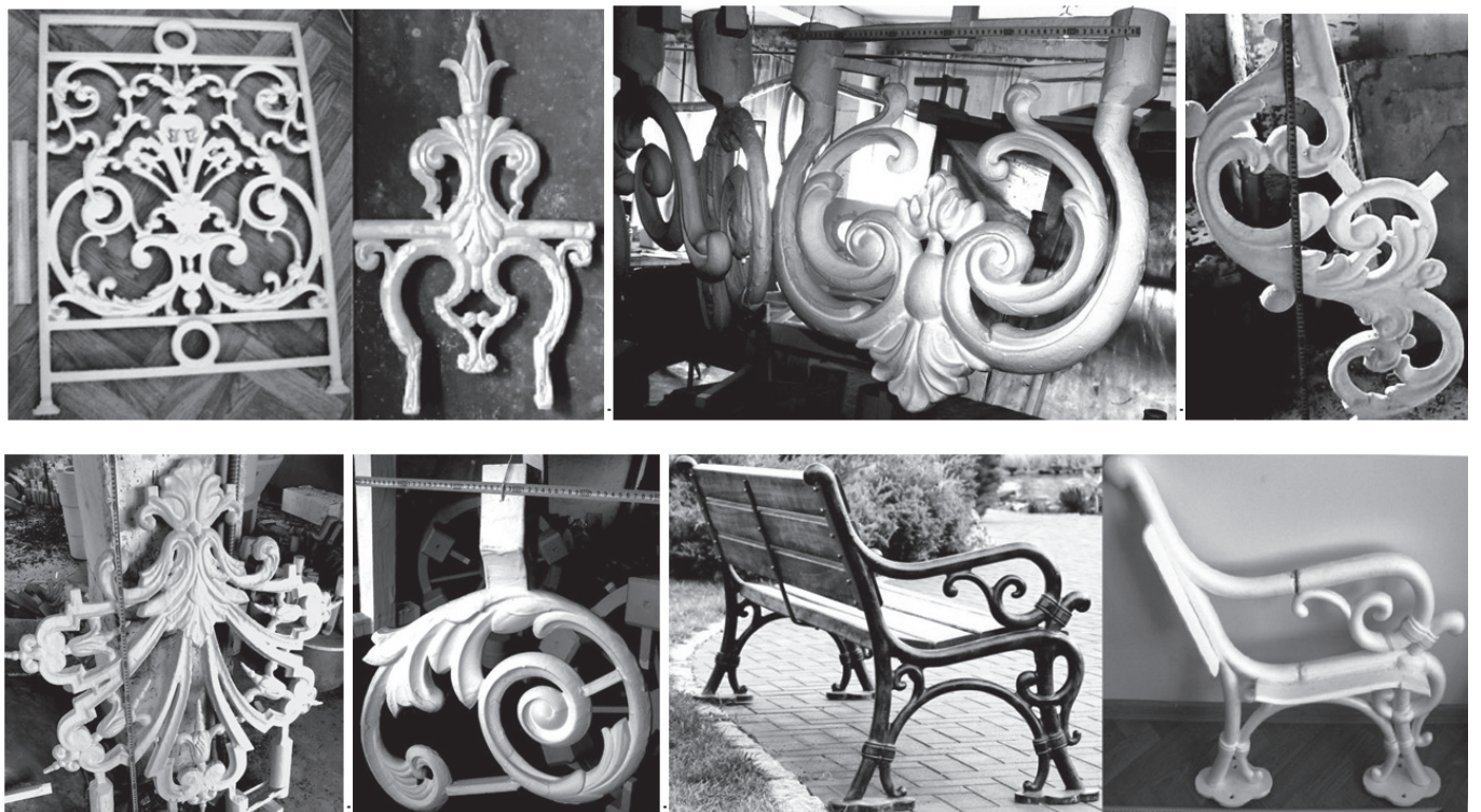
Рис. 7. Крупные модели отливок декоративных решеток ограждений, а также скамейка показана рядом с моделью
