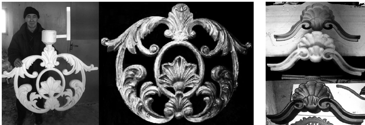
Рис. 12. Модель и отливка из нержавеющей стали детали ограждения, а также заготовка модели пресс-формы, модель и отливка детали декоративного ограждения
