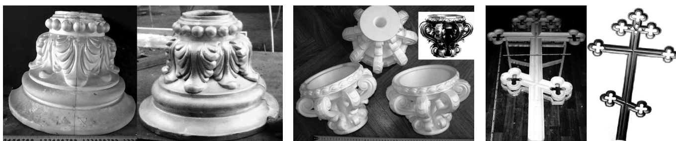
Рис. 10. Модель и пустотелая алюминиевая отливка подставки под колонну, 3 модели и отливка подставки под плафон уличного светильника, а также модель и отливка православного креста
