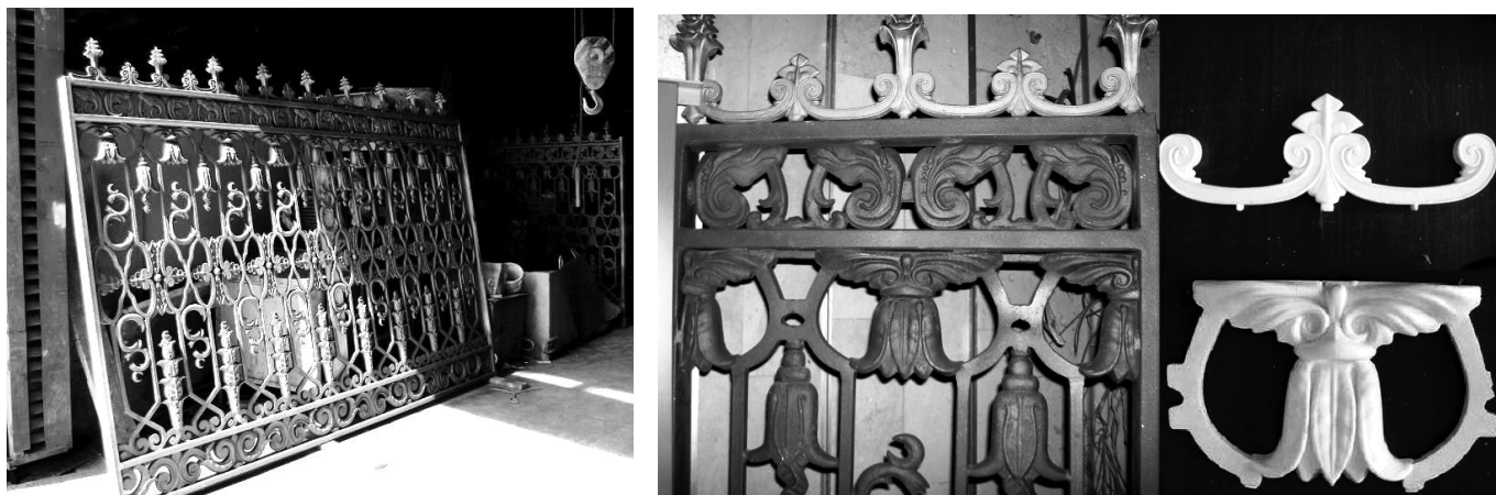
Рис. 8. Крупная лито-сварная секция декоративного ограждения из углеродистой стали в цехе ФТИМС НАН Украины, а также её фрагмент с моделями деталей
