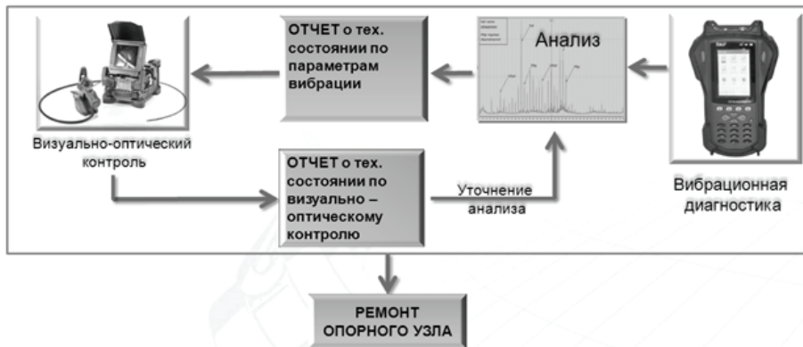
Рис. 2. Порядок проведения технической диагностики опорных подшипников конвертера
