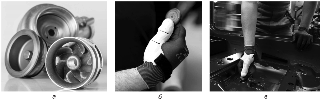
Рис. 9. Примеры использования 3D-технологии концерном BMW: а – деталь насоса; б, в – эргономичный инструмент (белого цвета) на руке работника
