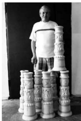
Рис. 1. Примеры изготовления моделей для ЛГМ на 3D-фрезерах
