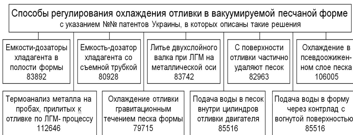
Рис. 1. Новые технические решения (с отличительными свойствами) по регулированию охлаждения отливки в вакуумируемой форме
