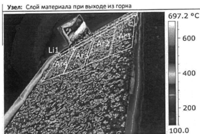
Рис. 3. Результаты термографического исследования равномерности распределения температурного поля по ширине паллета на выходе из горна в ходе эксплуатации ГУ СНТ-22
