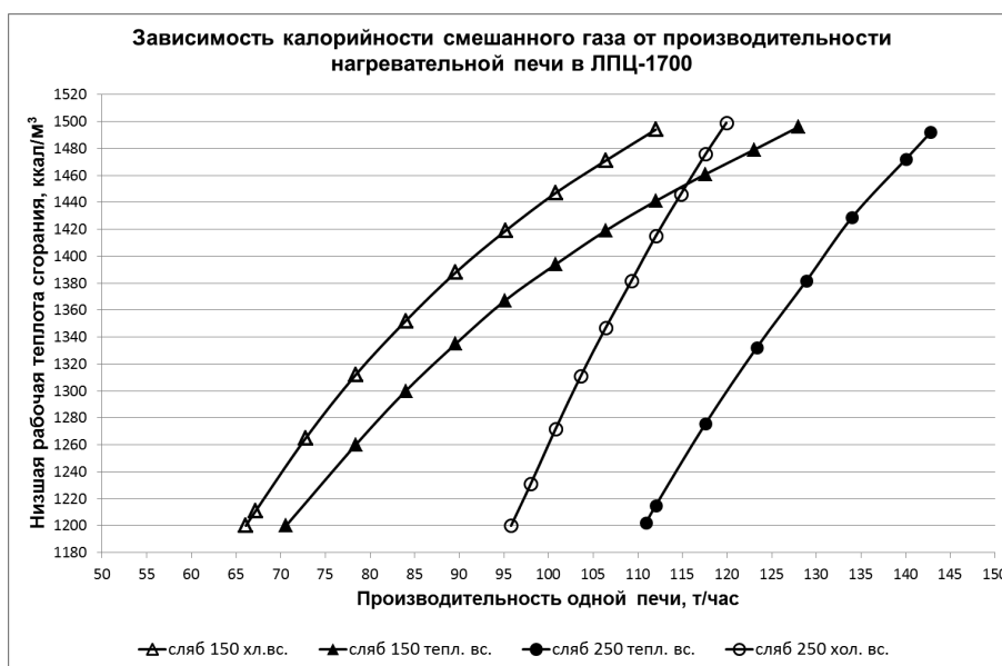
Рис. 3. Зависимость нижней рабочей теплоты сгорания топлива, подаваемого на нагревательные печи от производительности печи
