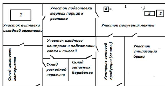
**Рис. 2.** Примерный план производства и размещения оборудования: 1 – печь для выплавки исходной заготовки; 2 – ВЧ-генератор (плавильный узел); участок входящих шихтовых материалов; 3 – установка по получению ленты; 4 – смотка (перемотка) ленты в рулоны; L – необходимое свободное расстояние (6-10 м)
