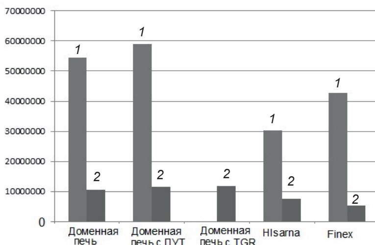
Рис. 3. Выбросы парниковых газов при производстве 22,93 млн. т чугуна на различных технологических агрегатах (1 – без CCS, 2 – с CCS)
