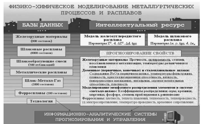
Рис. 3. Структура информационного ресурса о свойствах железорудных материалов, шлаковых и металлических расплавов «Расплав»
