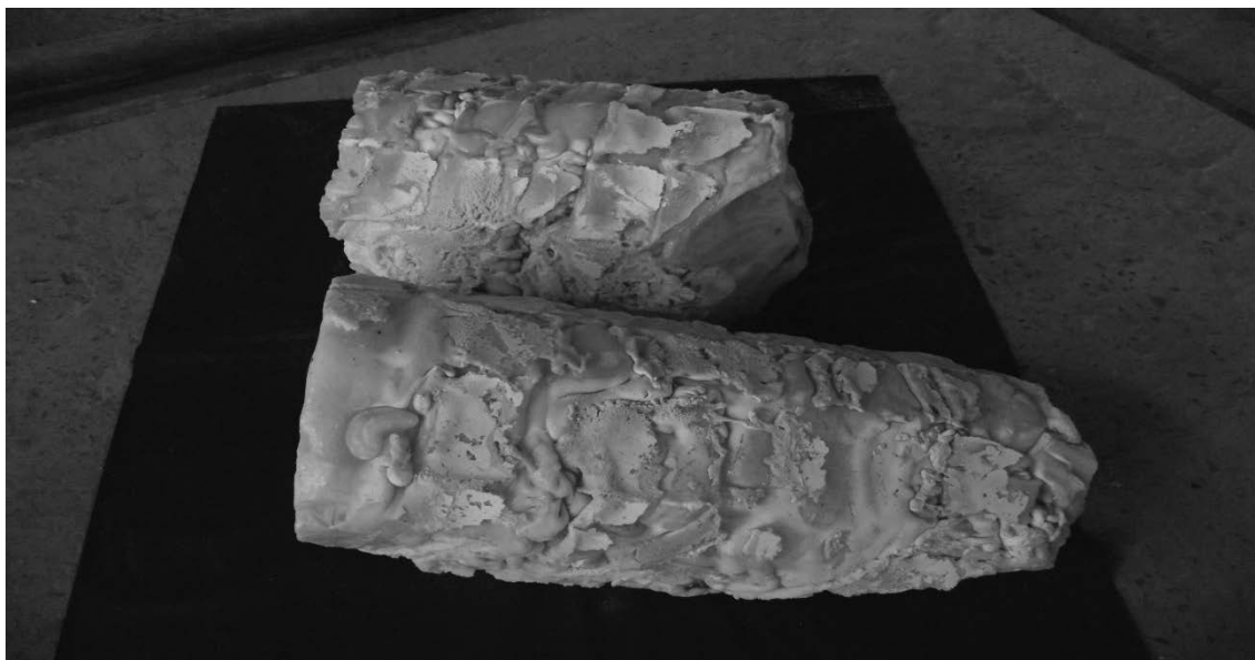
Рис. 5. Слиток плавленного кварца после воздействия плазмотроном
