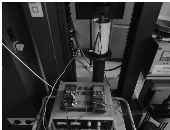
Рис. 2. Общий вид экспериментальной установки для определения УЭС
