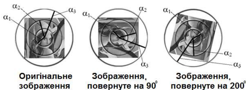
Рис. 3. Фази моментів \alpha_1, \alpha_2, \alpha_3 , обчислені для різних кругових сегментів R_1, R_2, R_3 оригінального зображення, і їх зміна в випадку повороту зображення навколо фронтальної осі
