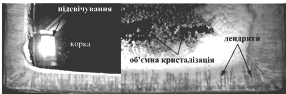
Рис. 3. Структура модельної речовини під час тверднення.
