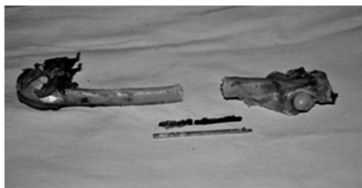
Рис. 5. Стегнова кістка кроля та видалений імплантат з магнієвого сплаву після 3 місяців експерименту порівняно з вихідним імплантатом.
