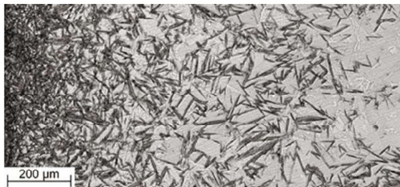
Рис. 4. Структура приповерхневої зони сталі 120Г3С2 після гартування від 1000 °С. Витримка при температурі перед гартуванням 30 хв.
