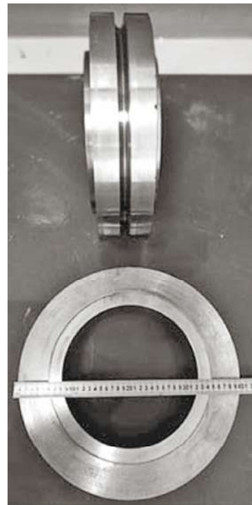
Рис. 2. Деталь (маса 47 кг, розміри: діаметр 400 мм, товщина 90 мм) зі сталі 4X4H5M4Ф2 для екструдера.
