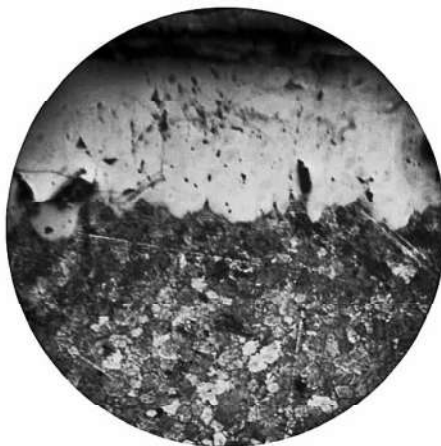
Рис. 1. Структура поверхні зразка з осадженим алюмінієм. \times 70 .
