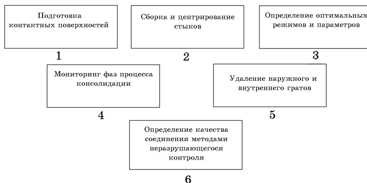
Рис. 1. Последовательность основных операций при стыковой сварке трубопроводов.
