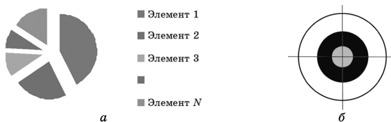
Рис. 1. Круглый катод, состоящий из нескольких секторов по числу элементов ( a ); центрально-симметричный круглый катод с несколькими вставками ( б ).
