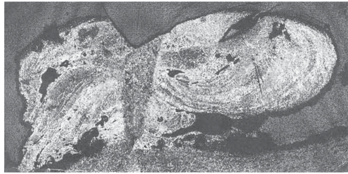
Рис. 5. Макроструктура грата, образованного при выдавливании жидкого металла при КСО ( \times 4 ).
