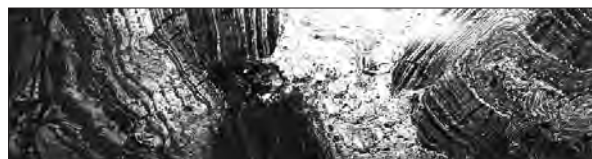
Рис. 1. Позднедиагенетические деформации в железистом кварците. Кварцевые слои темные, рудные — светлые; полированный штупф, Саксаганское рудное поле, Криворожский район
