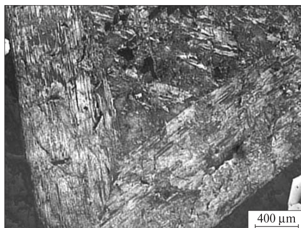
Рис. 5. Зональна і неоднорідна внутрішня будова арсенопіриту, виявлена структурним травленням (св. 689, гл. 751,0 м)
