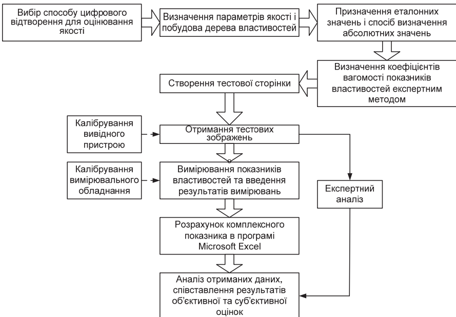
Рис. 3. Алгоритм комплексного оцінювання якості поліграфічної продукції, відтвореної цифровим способом
