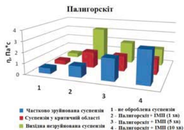
Рис. 4. Вплив імпульсного модульованого магнітного поля на в'язкість вихідної суспензії палигорскіту
