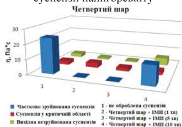
Рис. 5. Вплив імпульсного модульованого магнітного поля на в'язкість вихідної суспензії глини четвертого шару
