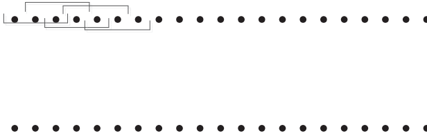
Рис. 1. Переміщення ковзного вікна при виконанні медіанної фільтрації
