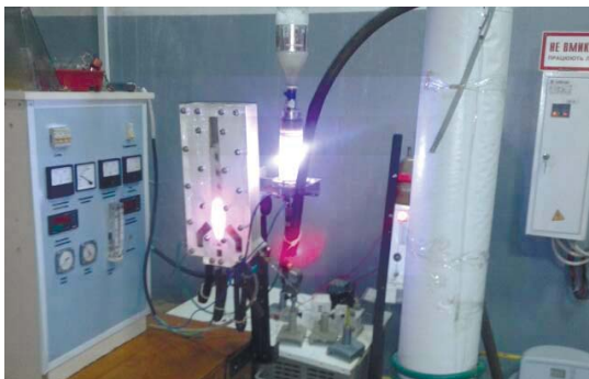
Рис. 3. Деструктор стійких органічних забруднювачів на базі плазмо-хімічної технології
