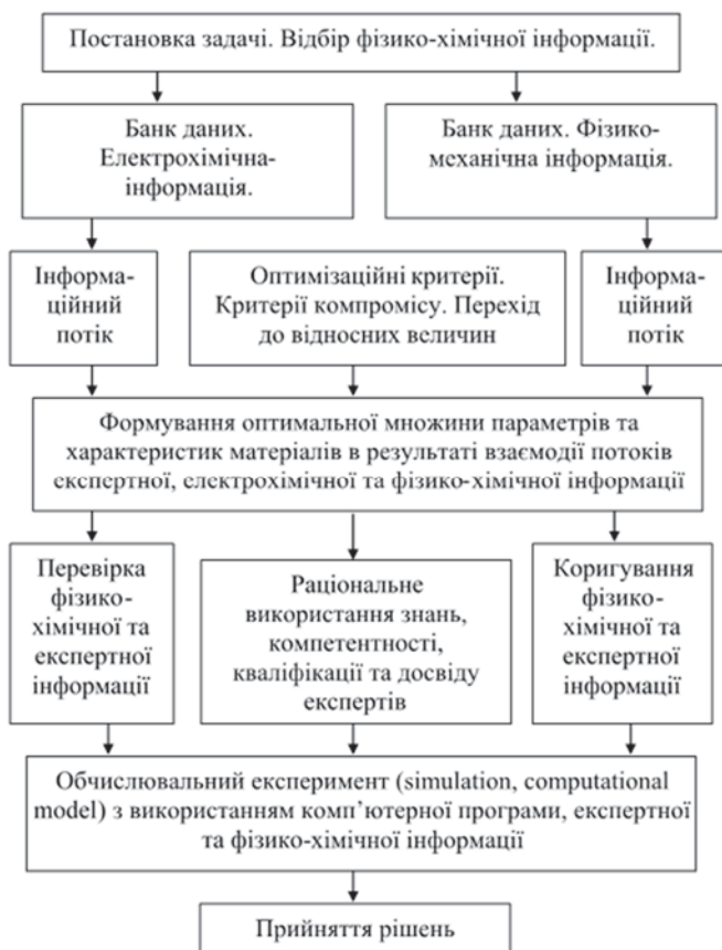
Рис. 5. Структура інформаційно-аналітичної моделі відбору, опрацювання і використання інформації про фізико-хімічні параметри контактуючих середовищ в задачі прийняття рішень щодо вибору оптимального варіанту марки сталі, якому відповідає максимальна міцність, мінімальна ціна і максимальний бар'єр потенціалу на границі «метал – електроліт, насичений сірководнем».
