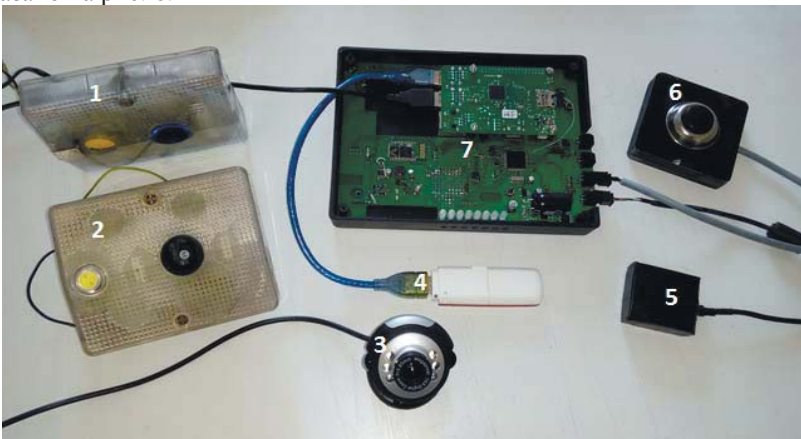
Рис.6. Приклад контролера (1 – плафон з передньою камерою, 2- плафон з задньою камерою, 3- USB-камера на посвідчення, 4 – GSM-модуль, 5 – GPS модуль, 6 – кнопка на посвідчення)
