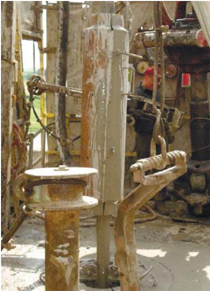
Рис. 3. Забруднення території бурової установки при спуско-піднімальних операціях: а) розливи бурового розчину при сифонах; б) саморобний очисний пристрій
