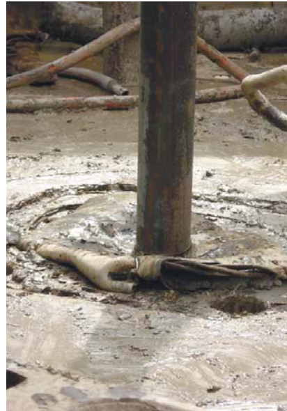
Рис. 3. Забруднення території бурової установки при спуско-піднімальних операціях: а) розливи бурового розчину при сифонах; б) саморобний очисний пристрій
