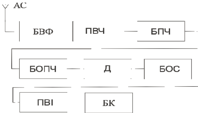
Рис. 1. Узагальнена схема радіоприймача для прийому і обробки радіосигналу.
