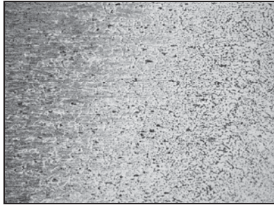
Рис. 1. Структура металу ЗТВ стикових з'єднань пластин з алюмінієвого сплаву АМг6
