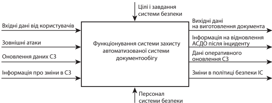
Рис. 1. Функціональна модель системи захисту АСДО верхнього рівня
