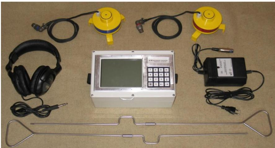
Рис. 6. Двухканальный акустический течеискатель А-20 с двумя датчиками для грунта
