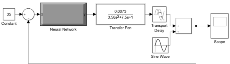
Рис. 7. Функціональна схема моделювання систем керування з ШНМ в Simulink.
