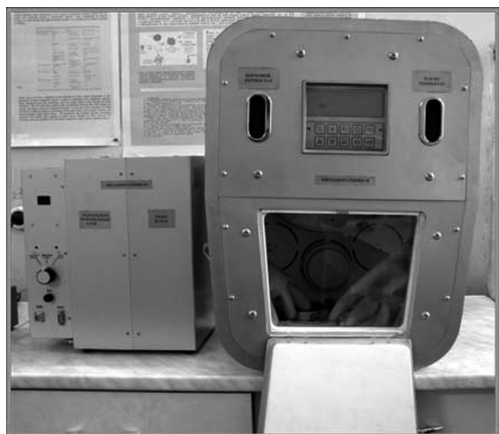
Биолаборатория-М. Холодильно-морозильный блок и макет термостата
