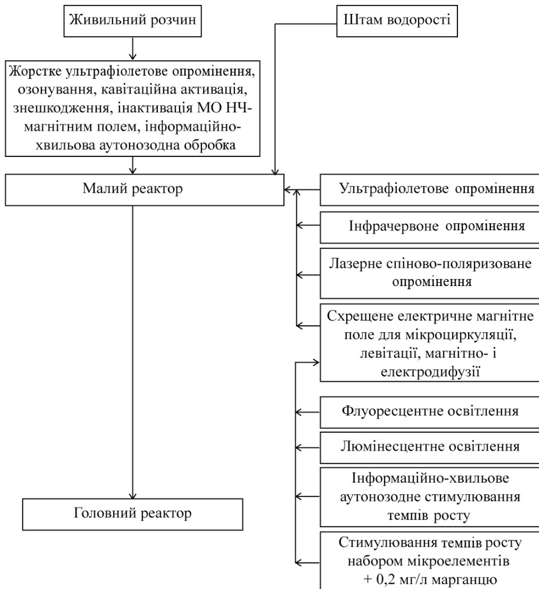
Рис. 10. Функціональна блок-схема малого реактора для підтримання життєдіяльності чистого штаму водоростей
