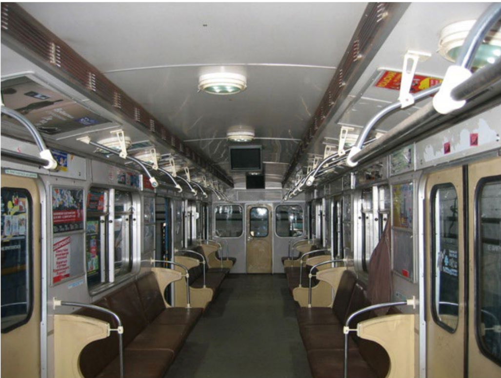
Рис. 3. Загальний вигляд вагону серії «Є», обладнаного світильниками розробки ІПММС
