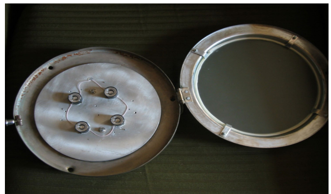
Рис. 2. Внутрішній вигляд світильника для освітлення салону вагонів серій «Є» та «Єж»
