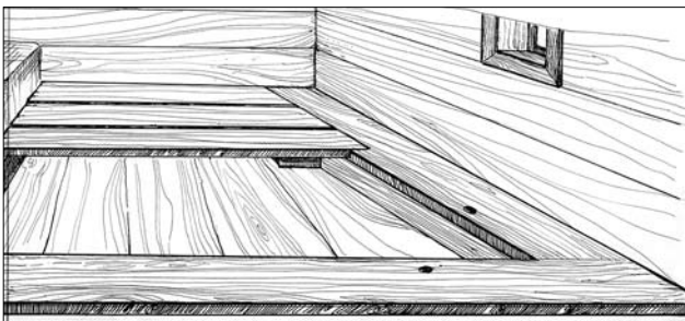
Фрагмент конструктивного з'єднання «задньої» нерухомої лави і спального місця «полу» у хаті кін. XIX ст., с. Снідавка (Косівський р-н Івано-Франківська обл.) (Гуцульщина). Рисунок В. Сивака
