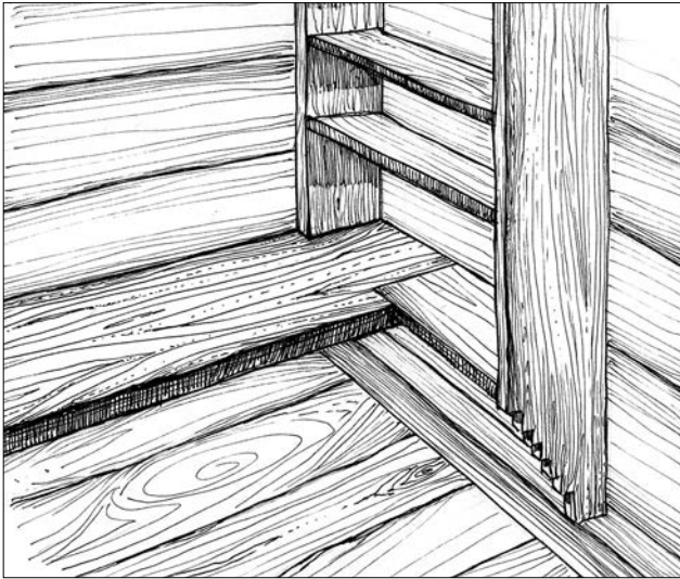
Фрагмент конструктивного з'єднання «передньої» лави і мисника у хаті кін. XIX ст., с. Максимець (Надвірнянський р-н Івано-Франківська обл.). Рисунок В. Сивака
