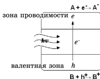
Рис. 1. Принцип действия фотокатализатора.
