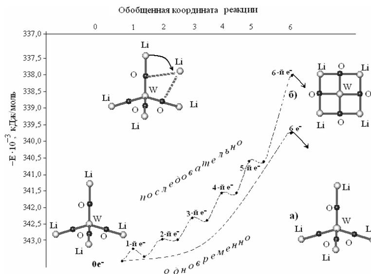
**Рис. 2.** Энергетический профиль ППЭ вдоль обобщённой координаты реакции *а*) одновременного и *б*) последовательного присоединения 6 электронов ЭАЧ  $\{\text{Li}_4^+[\text{WO}_4]^{2-}\}^{2+}$ .
