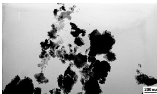
Рис. 1. Микрофотография композита \text{Al}_2\text{O}_3/\text{МУНТ} , содержащего 3% вес. УНС.
