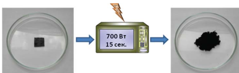
Рис. 3. Оптические фотографии плёнки ОГ до обработки в СВЧ-печи и продукт взрыва — ВОГ.
