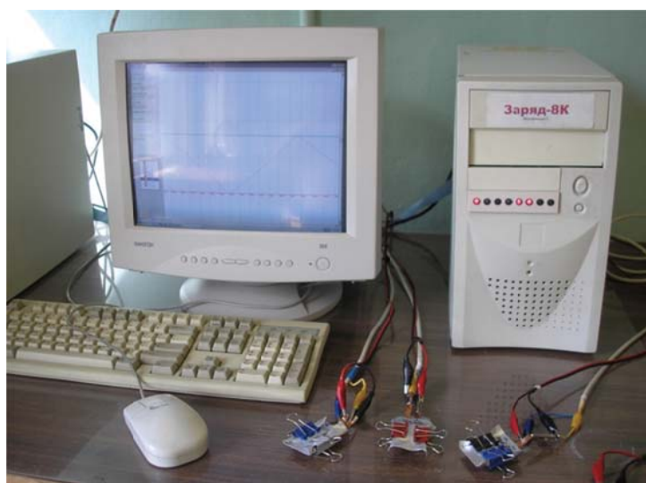
Рис. 5. Стенд «Заряд-8К» в процессе испытания пакетных СК.
