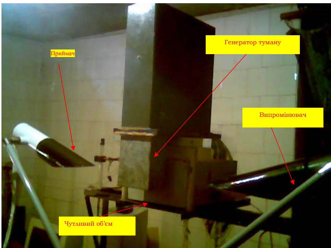
Рис. 5. Зовнішній вигляд компонування обладнання для визначення метрологічних характеристик датчика
